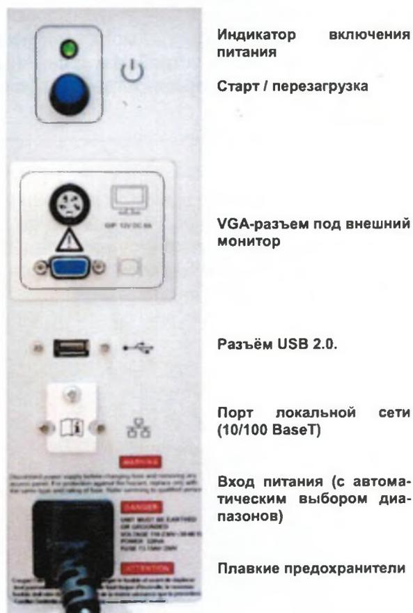
Рисунок 6: Соединительные порты на вычислительном блоке
