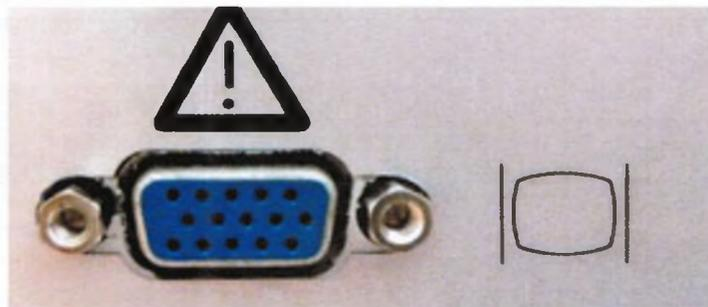
**Рисунок 8:** VGA-разъем для подсоединения внешнего монитора (дооснащение)
