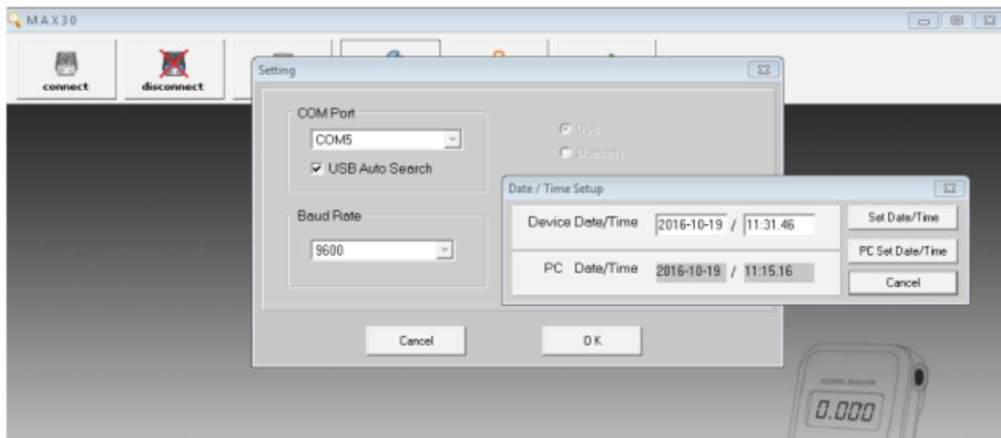
П.3.1.5 Для подключения нажмите виртуальную кнопку connect. Если установка программы и подключение анализатора к ПК произведены правильно, индикация USB на дисплее анализатора сменится на индикацию PC.
